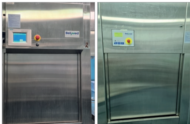
Рис. 5, 6. Паровой стерилизатор Belimed MST
