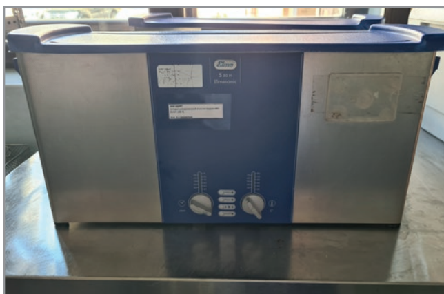
Рис.11. Ультразвуковая моющая машина Elma S80H
