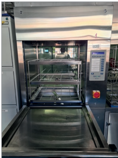
Рис.9, 10. Моечно-дезинфекционная машина Belimed WD250
