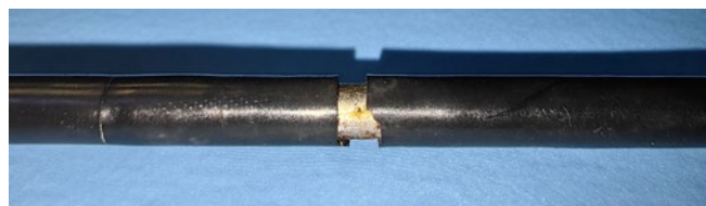
Рис. 23. Дефекты изоляции лапароскопических электроинструментов. А - в зоне эндоскопического обзора. Б - вне зоны эндоскопического обзора.
