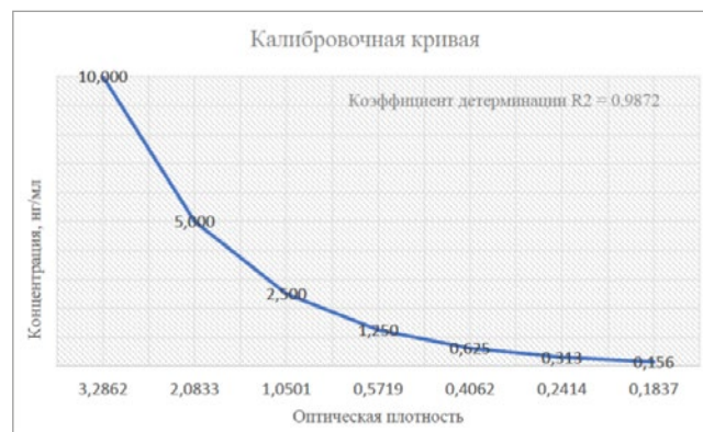
Рис. 1. Полученные результаты позволяют говорить о качественной работе ИФА-набора CloneCloud для определения уровня JAK-1 (коэффициент детерминации 0,9872, форма калибровочной кривой).
