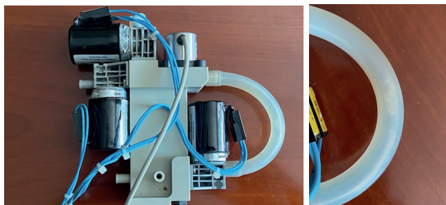
Рис. 3. Фрагменты узла диализного оборудования: общий вид. Визуализация внутренних отложений в трубосоединяющих системах
