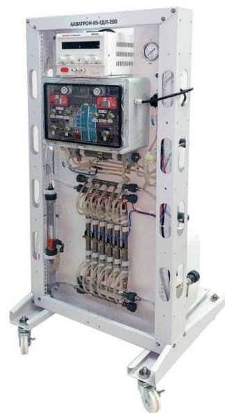
Рис. 5. Установка АКВАТРОН-05-ГДЛ-200 для синтеза метастабильных растворов активно действующих веществ с заданными свойствами и их целевого использования (дезинфекции и декальцинации) производительностью 200 л/ч
