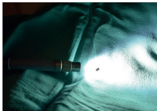
Рис. 3. Волоконно-оптический кабель прожигает хирургическое белье
