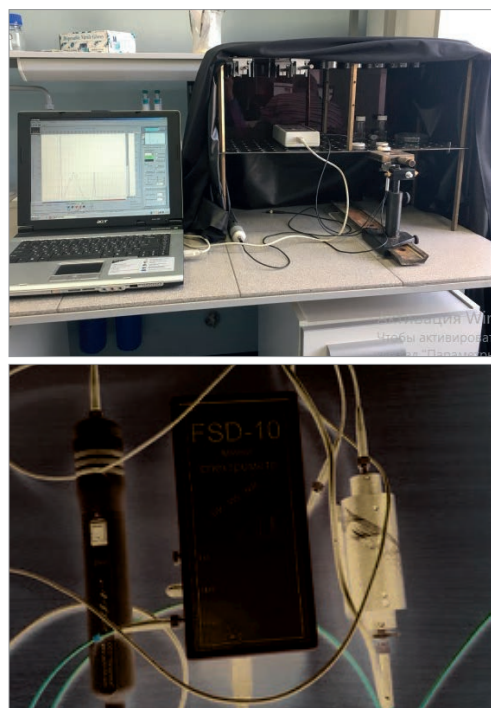
Рис. 1. Вид установки для люминесцентной спектроскопии (А — общий вид, Б — (слева направо) эксимерный лазер, спектрометр, фильтр для очистки сигнала)
